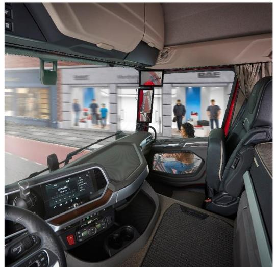
Die neue Rear View Camera zeigt auf einem Display im Fahrerhaus an, was am Heck des Lkws passiert. Der High Beam Assist (optional) schaltet das Fernlicht bei entgegenkommenden oder vorausfahrenden Fahrzeugen automatisch ab. Eine Funktion, die bereits in früheren DAF-Lkw verwendet wurde, ist ein Emergency Stop Signal, das andere Verkehrsteilnehmer durch Blinken der Warnblinkanlage warnt, wenn der Lkw stark abbremst.
