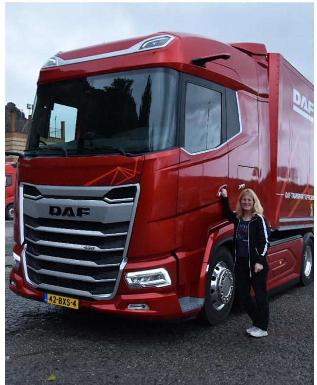
Auch der DAF XD 450 FAN gefällt. Mit dem Solofahrzeug fahren wir nach einem Stück Autobahn auf einer schmalen und kurvenreichen Strasse zurück. Hier bin ich im Element und kann den DAF so richtig austesten. Die verstärkte Motorbremse leistet hervorragende Arbeit und vermag die 26 Tonnen ohne Beihilfe der Fussbremse auf der steil abfallenden Strasse abzubremesen.
