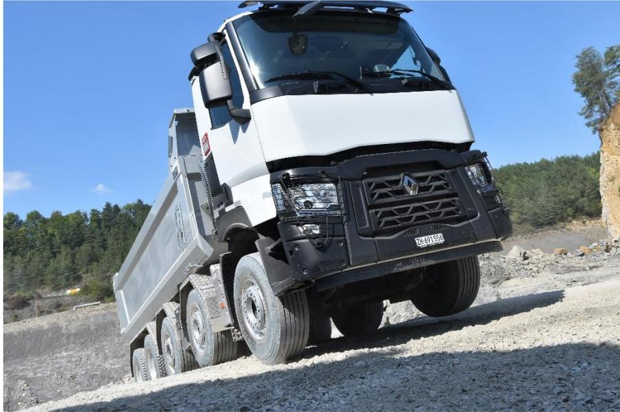
Beim Gang in die Waschstrasse zeigt sich ein weiteres Plus dieser Baustellenfahrzeuge. Einfach auf dem Gas bleiben und mit der Lenkradschaltung jeweils vor- und rückwärts schalten. So kann der Renault ohne Pedalwechsel vor- und zurückgefahren werden.
