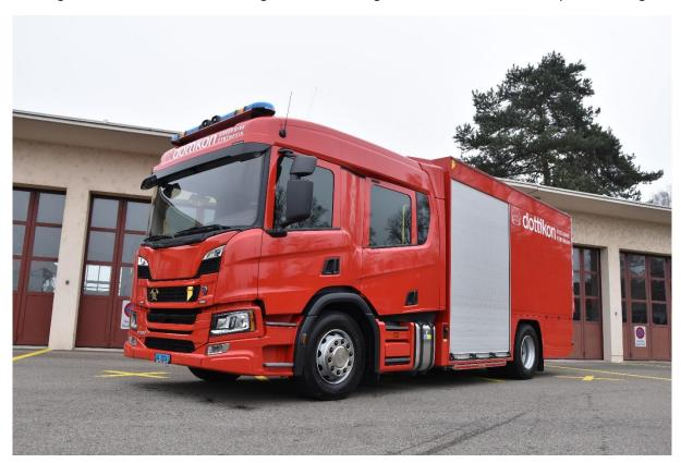
Der Scania P 360 B4x2NA ist mit dem 360 PS starken 9-Liter-Motor der neusten Abgasnorm Euro 6D und dem Wandler-Automatikgetriebe GA 766 ausgestattet. Speziell an diesem Fahrzeug ist die Mannschaftskabine CP 31 N mit Hochdach, welche erstmalig in dieser Form das Chassis prägt. Diese passt perfekt zur Höhe des Aufbaus und bringt dem Einsatzteam mehr Innenraum und
