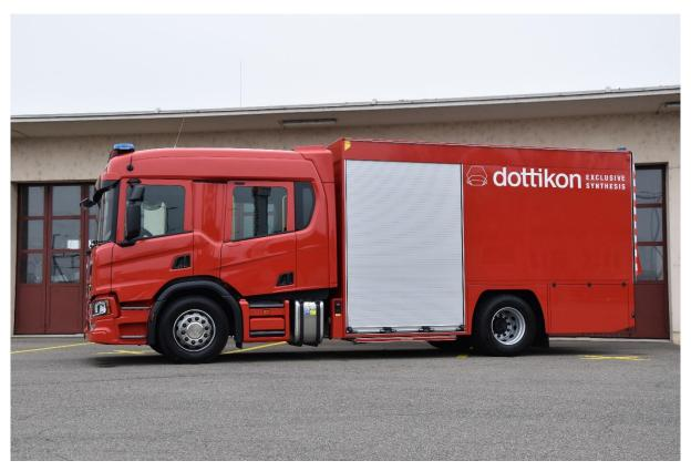
Der Scania P 360 B4x2NA ist mit dem 360 PS starken 9-Liter-Motor der neusten Abgasnorm Euro 6D und dem Wandler-Automatikgetriebe GA 766 ausgestattet. Speziell an diesem Fahrzeug ist die Mannschaftskabine CP 31 N mit Hochdach. Diese passt perfekt zur Höhe des Aufbaus und bringt dem Einsatzteam mehr Innenraum und Bewegungsfreiheit. Die Crew Cab ist mit vier Sitzen in Fahrtrichtung ausgestattet und beherbergt einen Teil der Ausrüstung der Chemiewehrtruppe.
