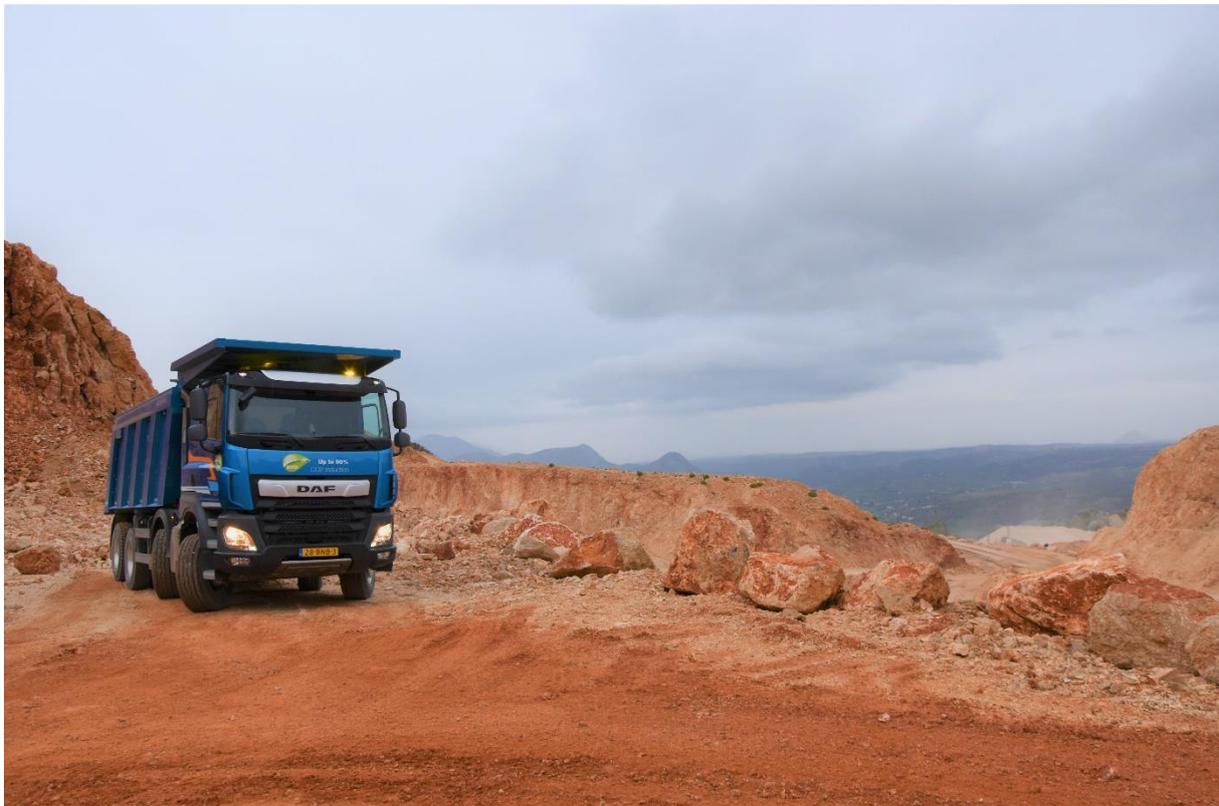
Dasselbe erleben wir auch mit dem 5-Achs-Kipper. Die mittlere Achse ist eine gelenkte Liftachse. Der CF 480 FAD Construction (10x4) federt die Unebenheiten der Strasse im Steinbruch locker ab und lässt sich angenehm lenken. Auch ohne eingeschalteten Offroad-Modus schaltet das Getriebe schnell und sauber.
